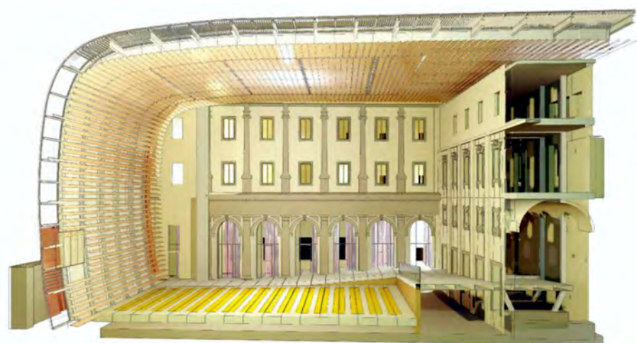
spaccato della corte-auditorium, configurazione piana
